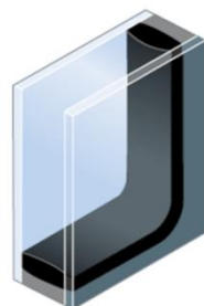
图 7，热塑隔条（TPS）系统中空玻璃的边部粘接
